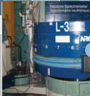
Un matériau cristallin diffracte le faisceau, c'est-à-dire qu'il divise le faisceau en fonction de l'énergie des neutrons. Une voie est placée de façon à permettre aux neutrons d'une certaine énergie désirée seulement d'atteindre l'échantillon de matériau. Les autres neutrons sont absorbés par la paroi du grand cylindre dans lequel se trouve le cristal.
