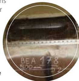
Section de tuyau de 0,5 m de diamètre avec une rainure de près de 0,4 m de long.
