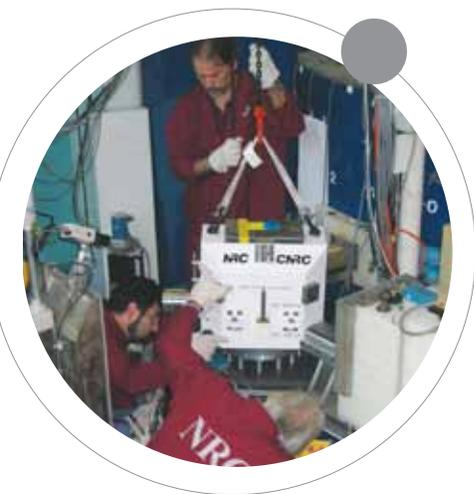
Personnel du CCFN chargeant une chambre spéciale contenant l'échantillon d'acier très radioactif sur la ligne de faisceau de neutrons pour faire des mesures de contrainte.
