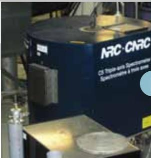
Un système de détection mobile permet de déterminer l'intensité du faisceau diffracté dans différentes directions.
